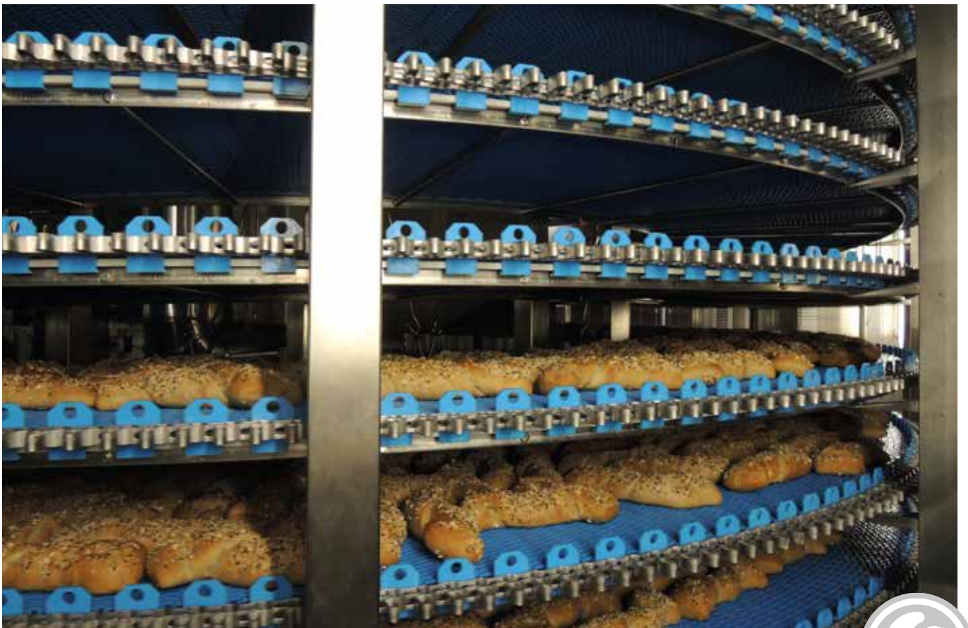
キャビネット内強制送風クーリング
